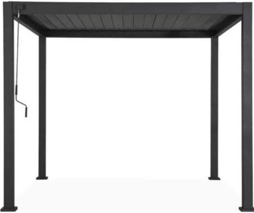
G001-2 AN ECOPERGOLA IN ALLUMINIO 3x3Mt. COL. ANTRACITE Palo: 115X115X1.5mm. 133X105X1.5mm 105x94x1.5mm Pali tetto: 134x20x1.5mm Tetto apertura singola Cod. 8 057685 608054 1pz: 4CTN
